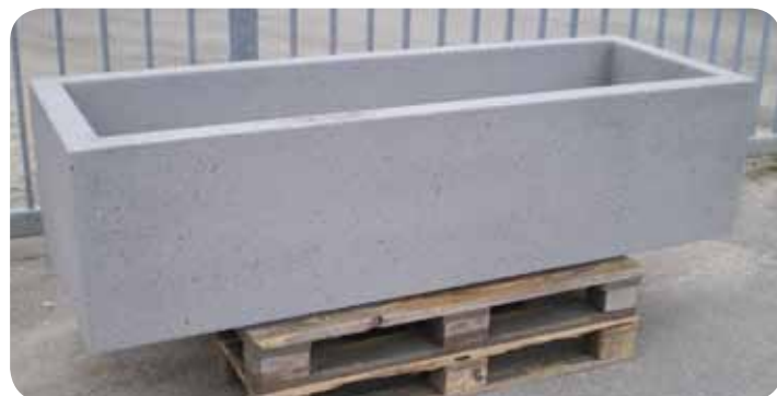
Der Trog in Sichtbeton-Qualität: mit Innenvibratoren nicht realisierbar. Für den Wassertrog setzte die Firma Kleih die neu angeschafften Wacker Neuson Außenvibratoren ein – mit hervorragendem Sichtbeton-Ergebnis.
